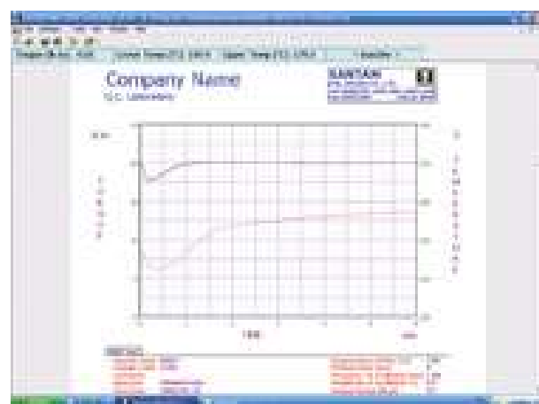
نمودار لحظه‌ای گشتاور و دماها کنترلرهای دما با پاسخدهی سریع
