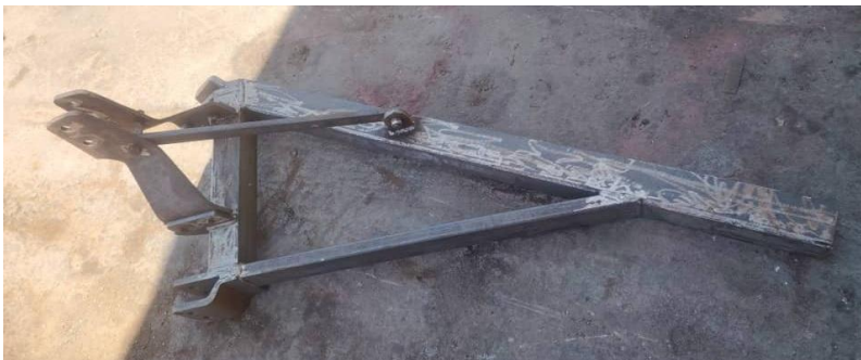
عکس ۲: شاسی و سه نقطه اتصال گاواهن از نمای بالا
